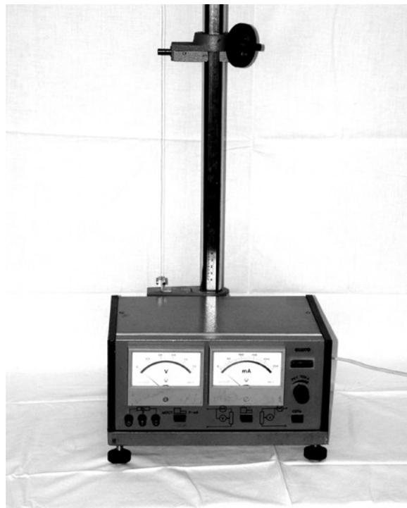
*Рис. 9.1. Установка для измерения удельного сопротивления тонкого провода*
