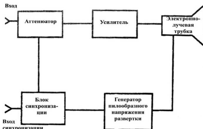
Рис. 2.5. Блок-схема осциллографа
